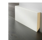
RODAPIÉ DE MDF LACADO EN COLOR BLANCO DE 10MM DE ESPESOR Y 40 MM DE ALTURA CON CANTO RECTO Y COLOCADO A INGLETE EN LAS ESQUINAS
